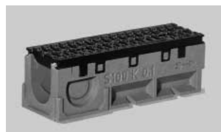
Žlab S 100 K, 0,5 m, typ 0.1 s postranním předtvarováním pro křížové, rohové a T-spoje
