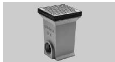
Dvorní vpust z polymerického betonu, litinový rám a rošt z pozinkované oceli - mřížkový, koš (PP), předtvarování s NBR-O-kroužkem pro nátrubek DN 100 a výjimatelný uzávěr pachů.
