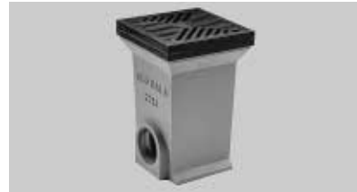
Dvorní vpust z polymerického betonu, litinový rám a rošt (GGG), koš (PP), předtvarování s NBR-O-kroužkem pro nátrubek DN 100 a výjimatelný uzávěr pachů.
